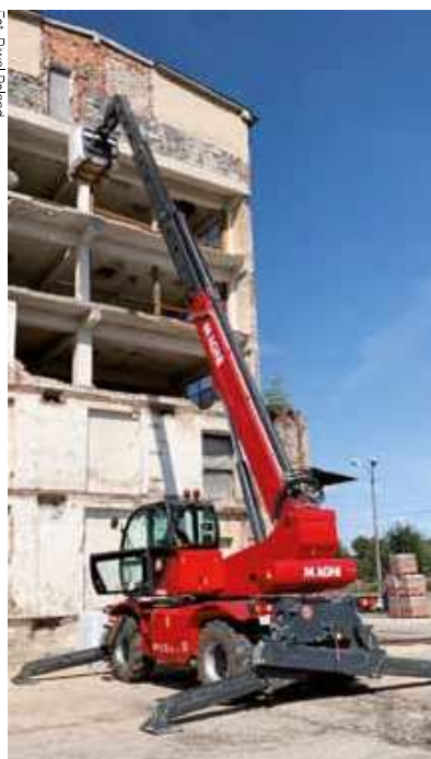
Ładowarka obrotowa Magni RTH 5.21SH ma 5 t udźwigu i 21 m maksymalnej wysokości podnoszenia
