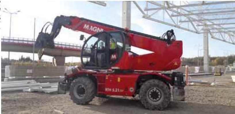
Ładowarka Magni RTH 5.21SH z osprzętem w postaci 5-tonowej wciągarki, używana przy rozbudowie fabryki Volkswagena w Poznaniu (również na dużym zdjęciu z lewej)
